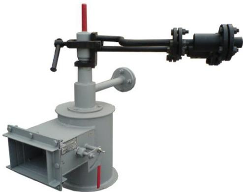
Особенностью горелки является герметичный воздуховод, приваренный к корпусу горелки, что позволяет ГДК-0,6Д применять в печах, имеющих в топочном объеме положительное давление. Кроме этого, газовые и жидкостные стволы скомпонованы в единый конструктивный узел, следствием чего являются небольшие габариты горелки. Количество дутьевого воздуха, поступающего в горелку определяется регулятором, находящимся в воздуховоде.
